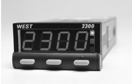
West 2300 数字显示器/控制器，具有体积小、功能全的特点，10mm LED 数码显示，2A 继电器和 3 线制 PT100 输入。该款控制器采用了 WEST 品牌先进的 PID 自整定算法。
